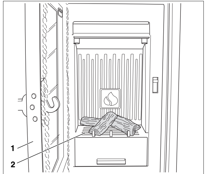
Abb. 19 Rost mit Holzscheiten
